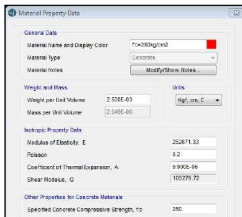
Figura Nro. 01: Definición del concreto  $f'c=280$  kg/cm<sup>2</sup>
