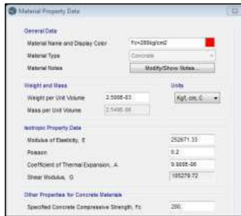
Figura Nro. 01: Definición del concreto f'c=280 kg/cm 2
